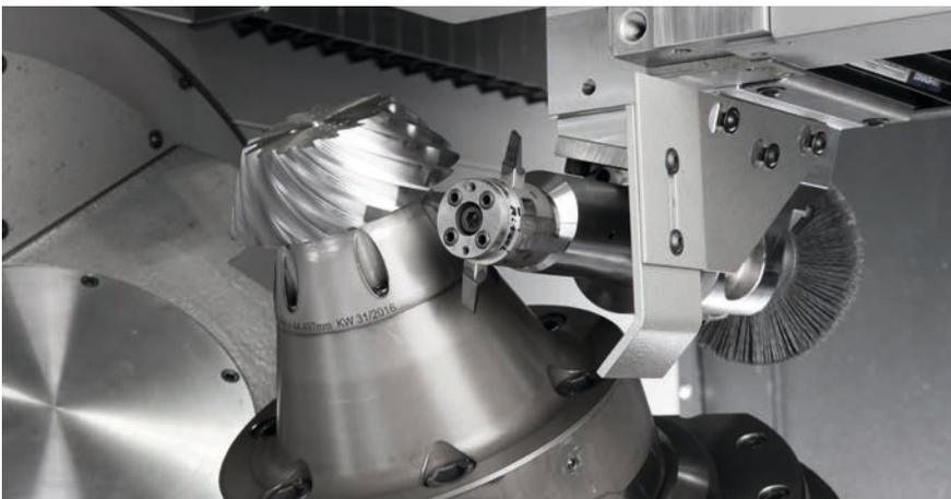
Abb. 4: Flexibles Entgraten in der Maschine
