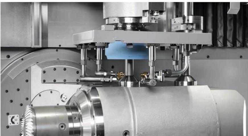
Abb. 5: Automatisches Aufnehmen der Schleifscheibe und Schleifölversorgung
